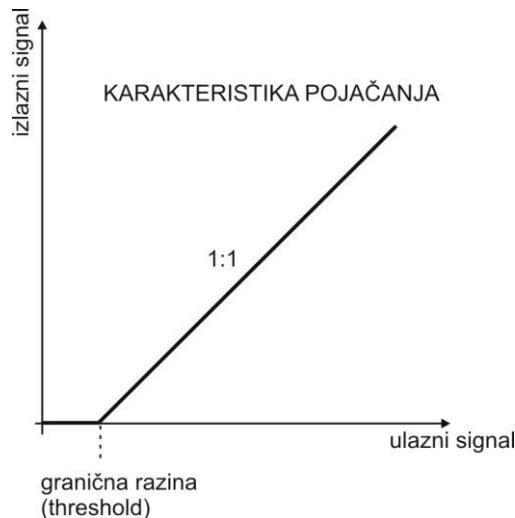
**Slika 3.44** Karakteristika pojačanja noise gate uređaja.
