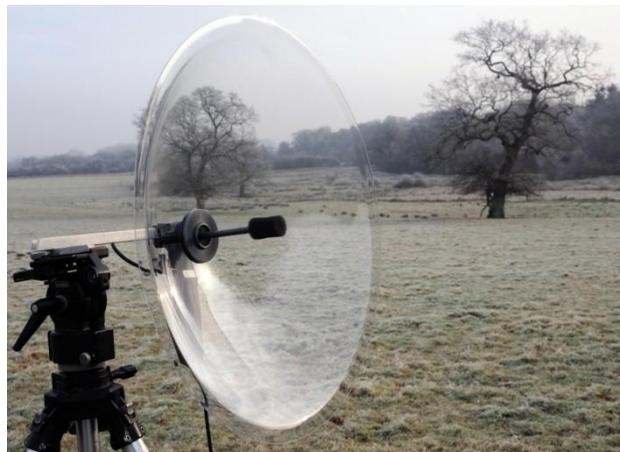
Slika 7.5 Parabolični mikrofon
